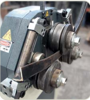
Opsiyonel Köşebent Büküm İçin Yan Dayamalar Optional Lateral Rolls For angle bending
