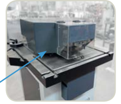
Zimba İstasyonu Punch Unit
