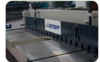
Döküm Taşlanmış tabla Cast Iron ground Table
