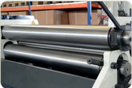
İndüksiyonlu Sert Miller Induction Hardened Rolls
