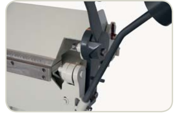
Kolay Çene Kilitleme mekanizması Easy Jaw lock mechanism
