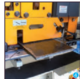
Lama kesme istasyonu Flat Bar cutting Station Резка листа
