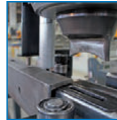
IPN/UPN ve Köşebent delme kalıbı IPN/UPN and angle punching tool Приспособление для пробивки IPN/UPN / уgolka
