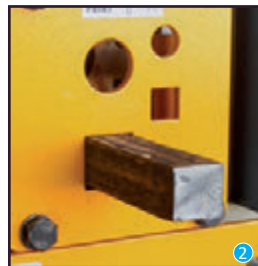
Kare dolu profil kesme istasyonu Square solid bar cutting station Резка квадратного прутка
