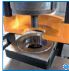
GDDA Zimba ölçüsü: 39 - 57 mm GDDA punch size 39-57 mm Адаптер для пробивки отверстий 39-57мм
