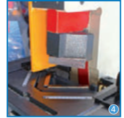
90° V köşe çıkartma kalıbı 90° V angle cutting tool Высечка V образная
