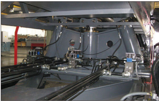
شکل ۶: سیستم تاب‌گیری بر روی دستگاه نورد جابجایی عمودی غلتک تحتانی را اندازه‌گیری کرده و میزان بار را در طول غلتک‌ها تنظیم می‌کند به طوری که تاب قطعه پس از شکل‌دهی وجود نخواهد داشت.
