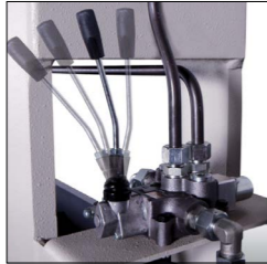
Özel çift hız kumanda kolu Dual Speed Joystick
