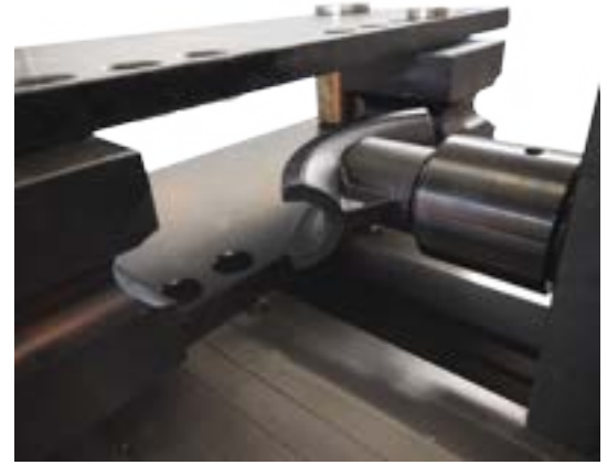
Opsiyonel boru bükme aparatı ve kalıpları Optional pipe bending attachments and tools
