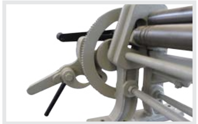
Dişli Ay Çarkı ile hızlı Arka-Top ayarlama With Geared Lock, Easy Backr Roll Adjustment
